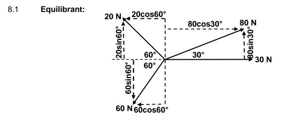
$\Sigma HC = 30 + 80 \text{cos} 30^\circ - 20 \text{cos} 60^\circ - 60 \text{cos} 60^\circ$
