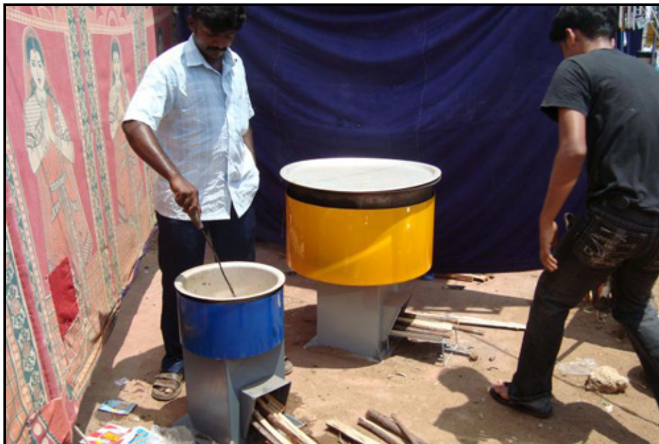
FIGUUR A: ODOM-stoof-prototipe deur die MOBY Institutional and Prakti Design Lab vir die brand van rooklose, energiedoeltreffende houtskool-brikette wat 70% minder hout as tradisionele stowe gebruik (Indië), 2010.
