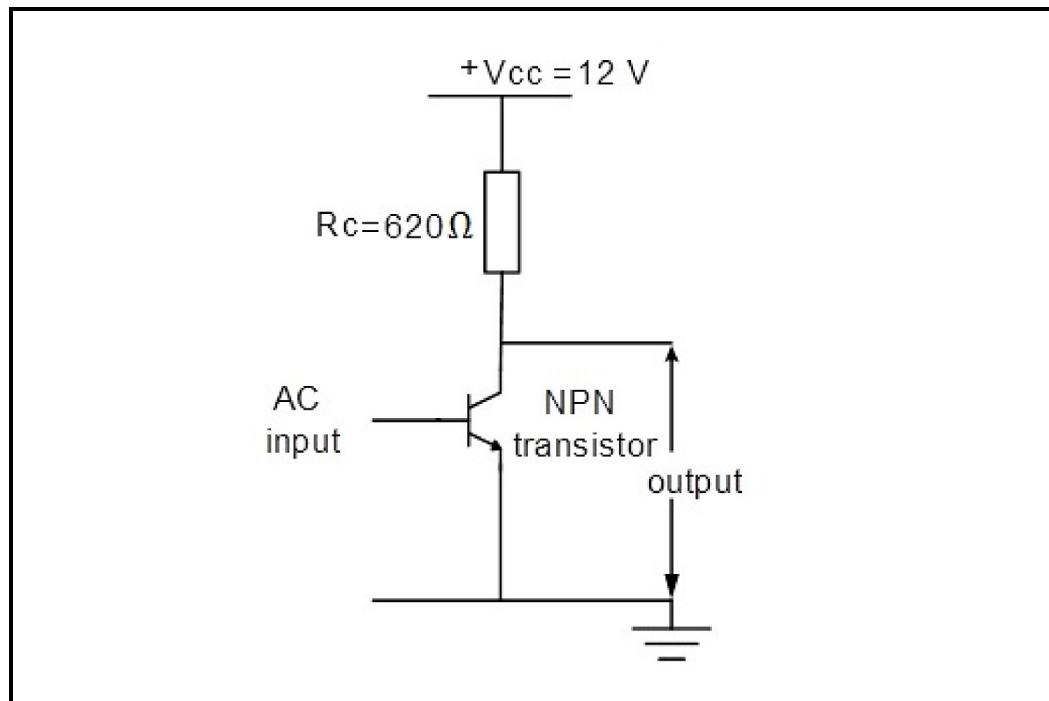
**FIGURE 6.1: BIASED NPN TRANSISTOR**
